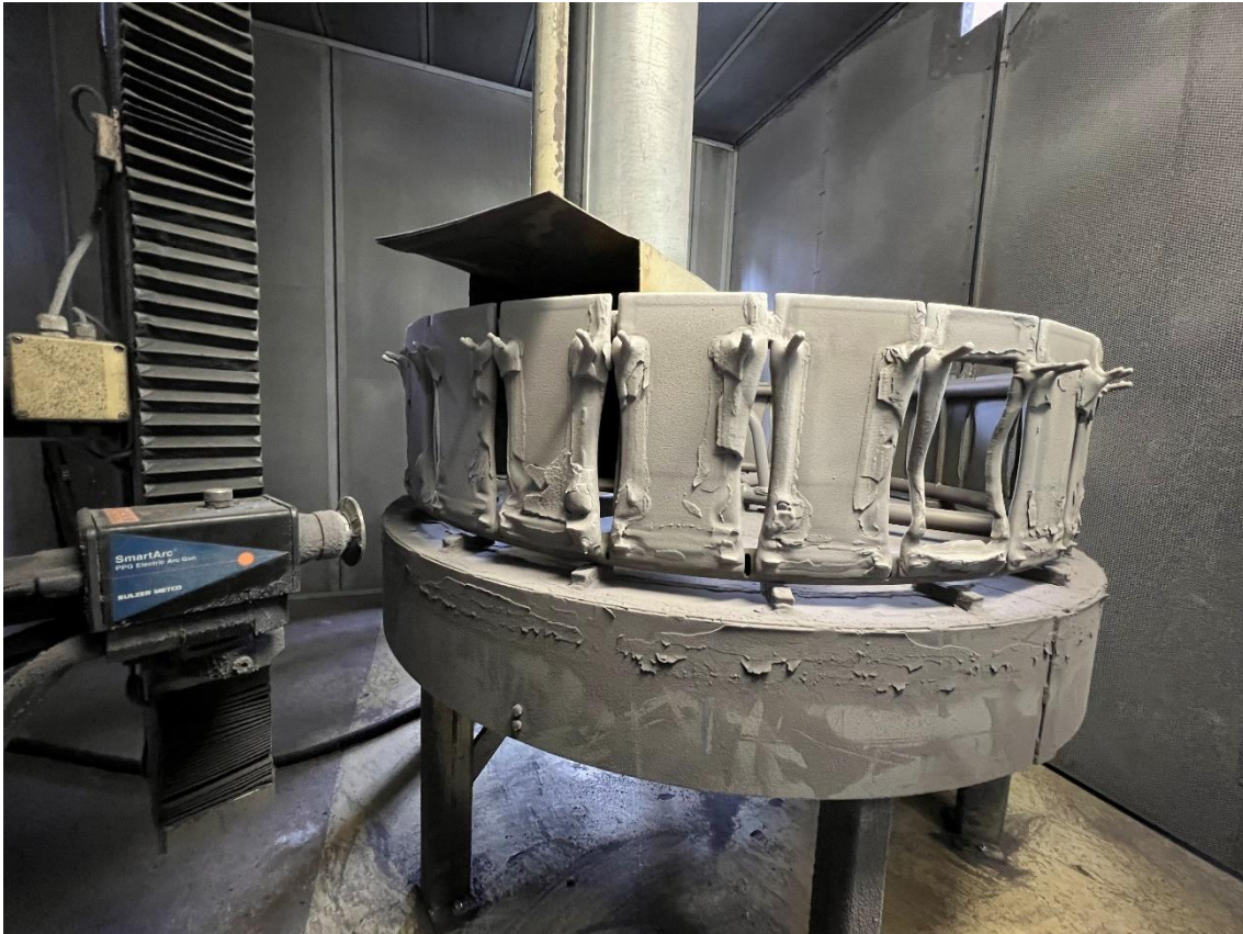
Abbildung 16: Innenansicht der Beschichtungsanlage für große Losgrößen gleicher Bauteile (Karussellanlage)
